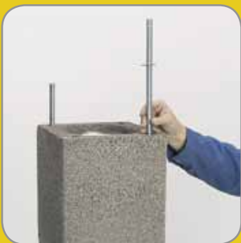
8.1 Csavarjuk össze a két-két merevítő pálcát az egy-egy fedkő rögzítő csavarral, és átlós-an helyezzük két sarokfuratba.
